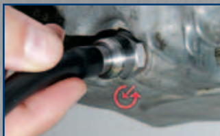
4. Schlauchanschluss mit viertel Umdrehung entriegeln und abziehen.
