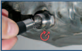
2. Schlauchanschluss aufstecken und mit viertel Umdrehung verriegeln.
